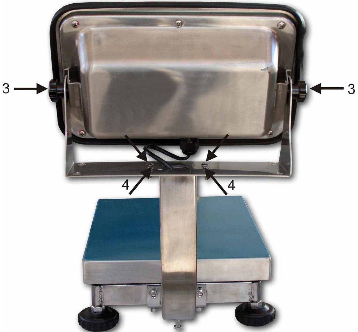
Stativ mit den 4 Linsenkopfschrauben [4] und Muttern an der Halterung des Anzeigegerätes befestigen.
